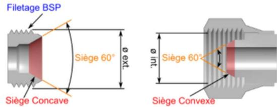
Le raccord BSP (British Standard Pipe) désigne la forme du filetage gaz et la façon dont l'étanchéité est faite.
