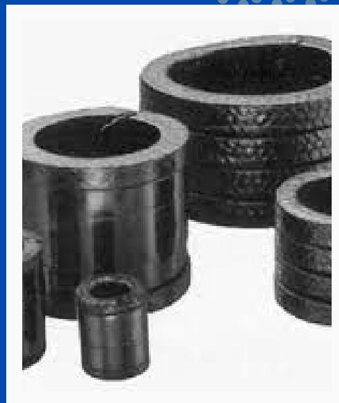
Les bagues matricées en graphite sont des joints obtenus avec un ruban en graphite expansé pur enrichi avec un inhibiteur de corrosion, enroulé en spirale à l'intérieur d'un moule.
