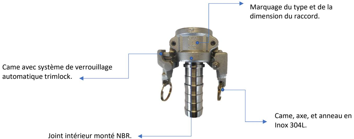
Le raccord à cames Trimlock est un raccord rapide, où deux parties, mâle et femelle, s'emboîtent l'une dans l'autre. La partie mâle est appelée adaptateur, la partie femelle coupleur. Tous les adaptateurs peuvent se raccorder à tous les coupleurs.
